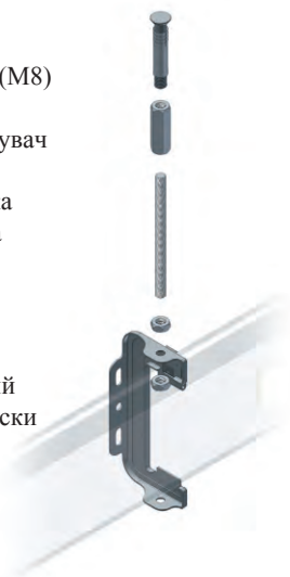
Монтаж до стелі
