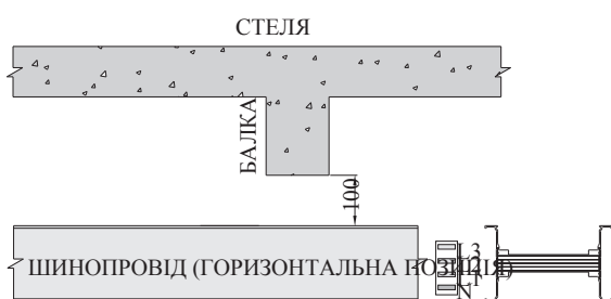
Малюнок 3. Приклад розташування 2-х шинопроводів шинами «вертикально»
