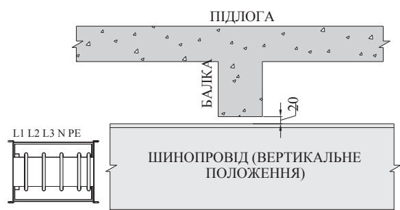
МІН.7 - ПРОХІД ЧЕРЕЗ БАЛКУ (ВЕРТИКАЛЬНЕ ПОЛОЖЕННЯ)
