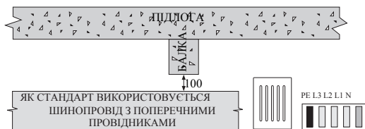
МАЛЮНОК 5 - ЗАСТОСУВАННЯ ШИНОПРОВІДУ З ПОЗДОВЖНИМ РОЗТАШУВАННЯМ ПРОВІДНИКІВ ДЛЯ ПЕРЕХОДУ ПІД БАЛКОЮ
