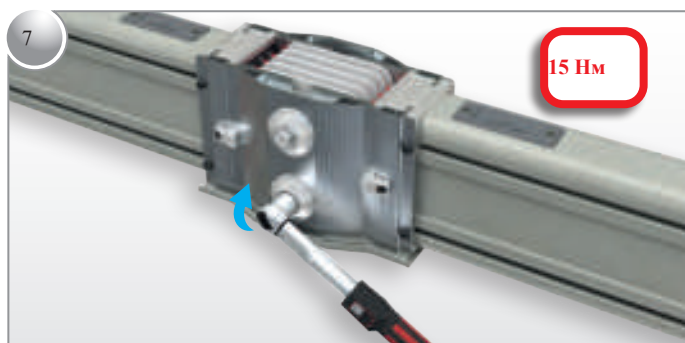
Знову встановлюються та затягуються кришки кріпильних болтів моментом 15 Нм.
