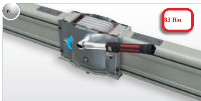
Після перевірки вирівнювання затягуються болти з'єднувального блоку моментом 83 Нм.
