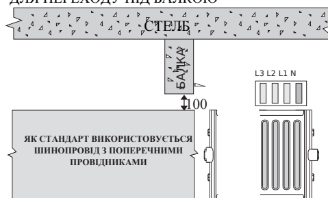
МАЛЮНОК 4 - ЗАСТОСУВАННЯ шинопровіду з ПОПЕРЕЧНИМ РОЗТАШУВАННЯМ ПРОВІДНИКІВ ДЛЯ ПЕРЕХОДУ ПІД БАЛКОЮ
